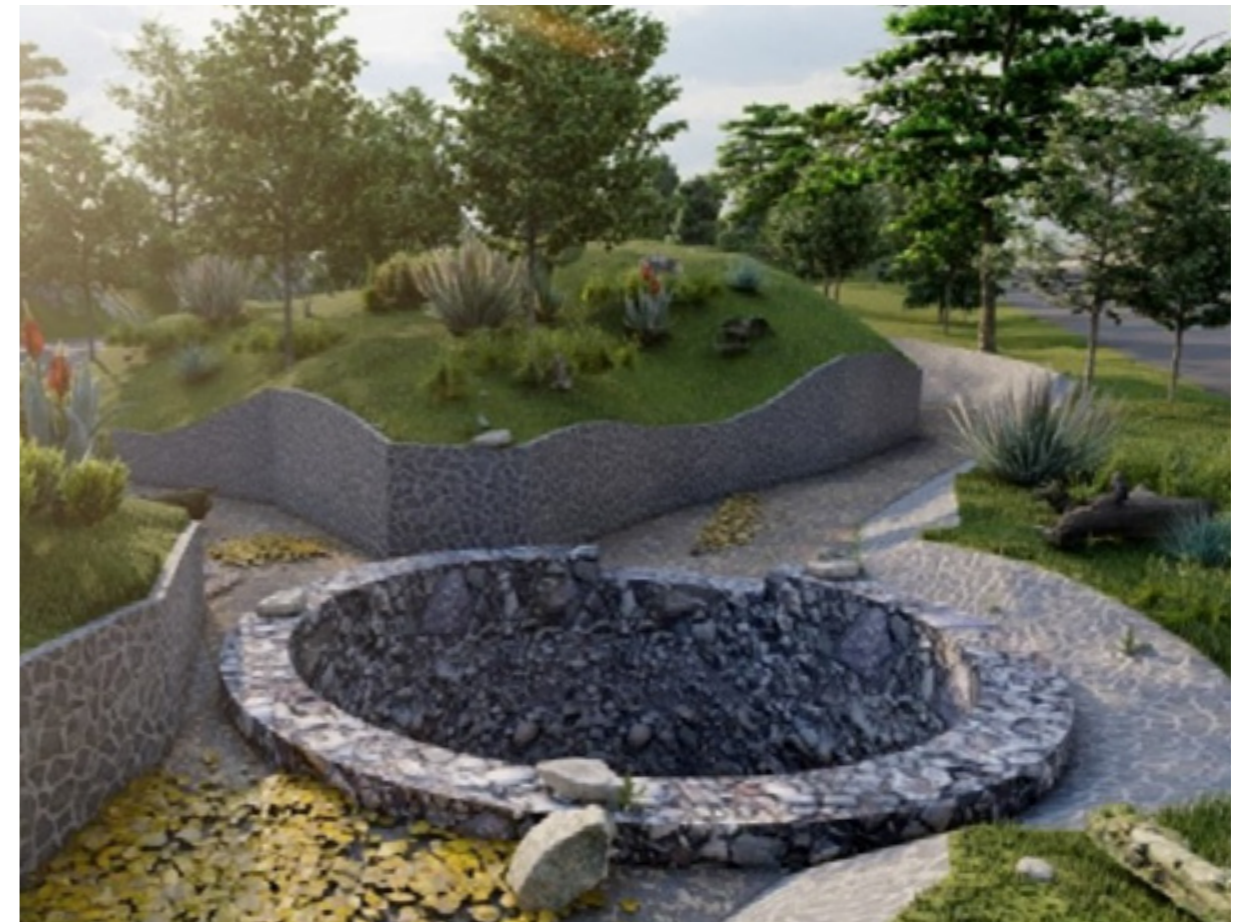
Sumidero de infiltración de agua pluvial
