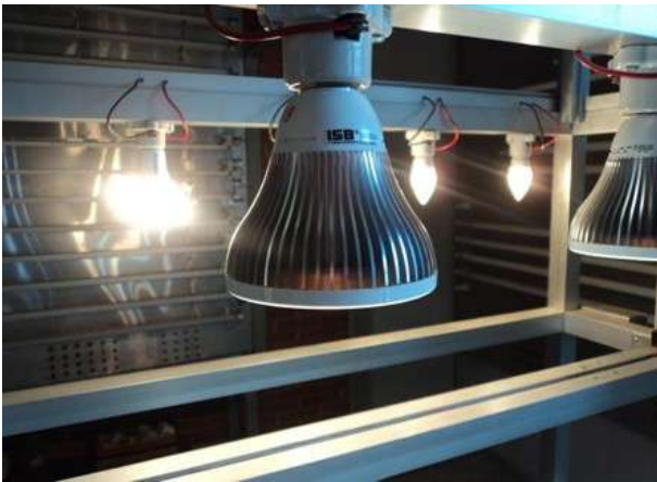
Pruebas de niveles de iluminación
