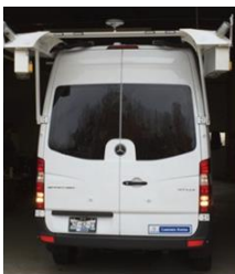
Sistema para detección de grietas o LCMS
